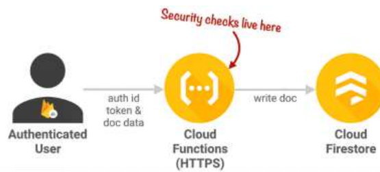
Сурет 3.3 – Токен мен деректерді тексеру арқылы Cloud Function арқылы Firestore-қа қауіпсіз қолжетімділік схемасы
