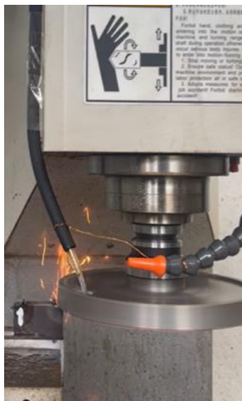
Сурет 3.7— Импульстік салқындатумен термофрикциялық фрезерлеу (ИС бар ТФФ) үрдісі.
