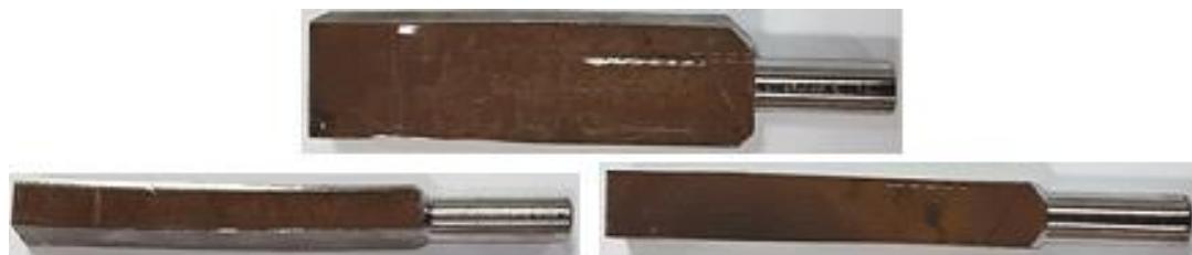
Сурет 3.12– HARDOX 450 болатынан дайындалған дайындама үлгілері
