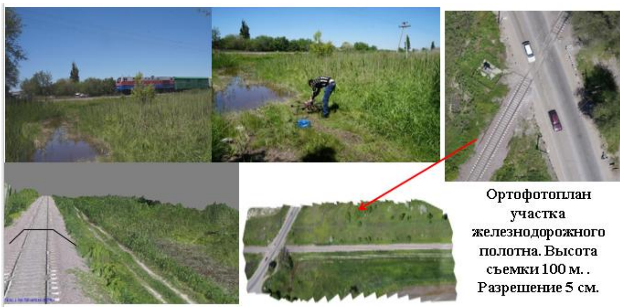
Рисунок 64 - Ортофотоплан участка железнодорожного полотна. Высота съемки 100 м. Разрешение 5 см
