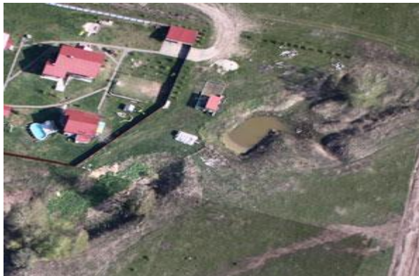
Рисунок 55 – Фрагмент ортофотоплана без выравнивания яркости
