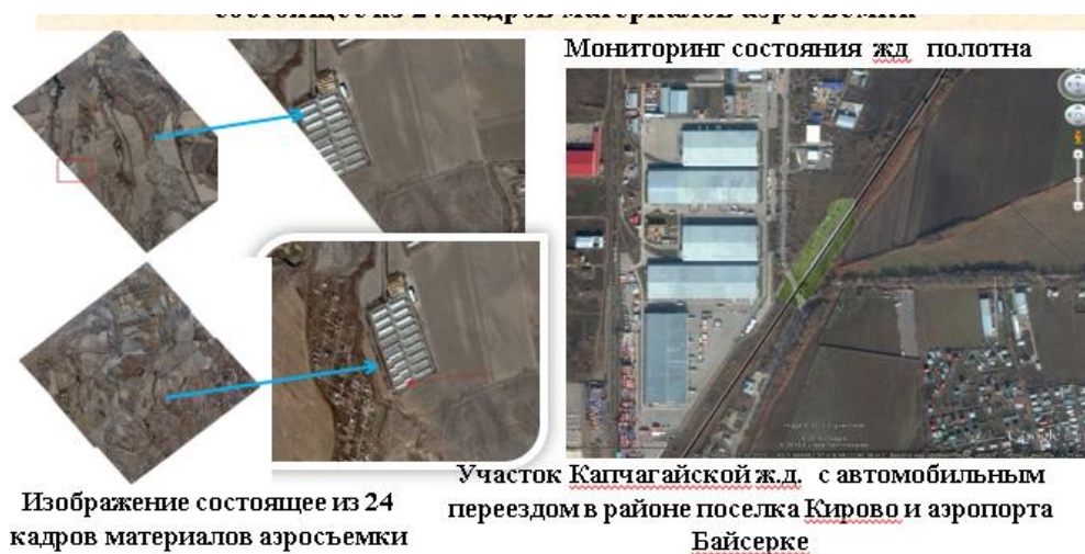
Рисунок 43 – Результаты работы программы построения накладки монтажа
