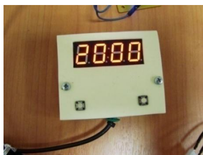
а) таймер с программатором и выставленным интервалом 2 секунды
